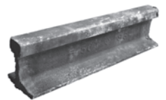
姫路モノレールのレール 姫路市蔵(手柄山交流ステーション保管)
